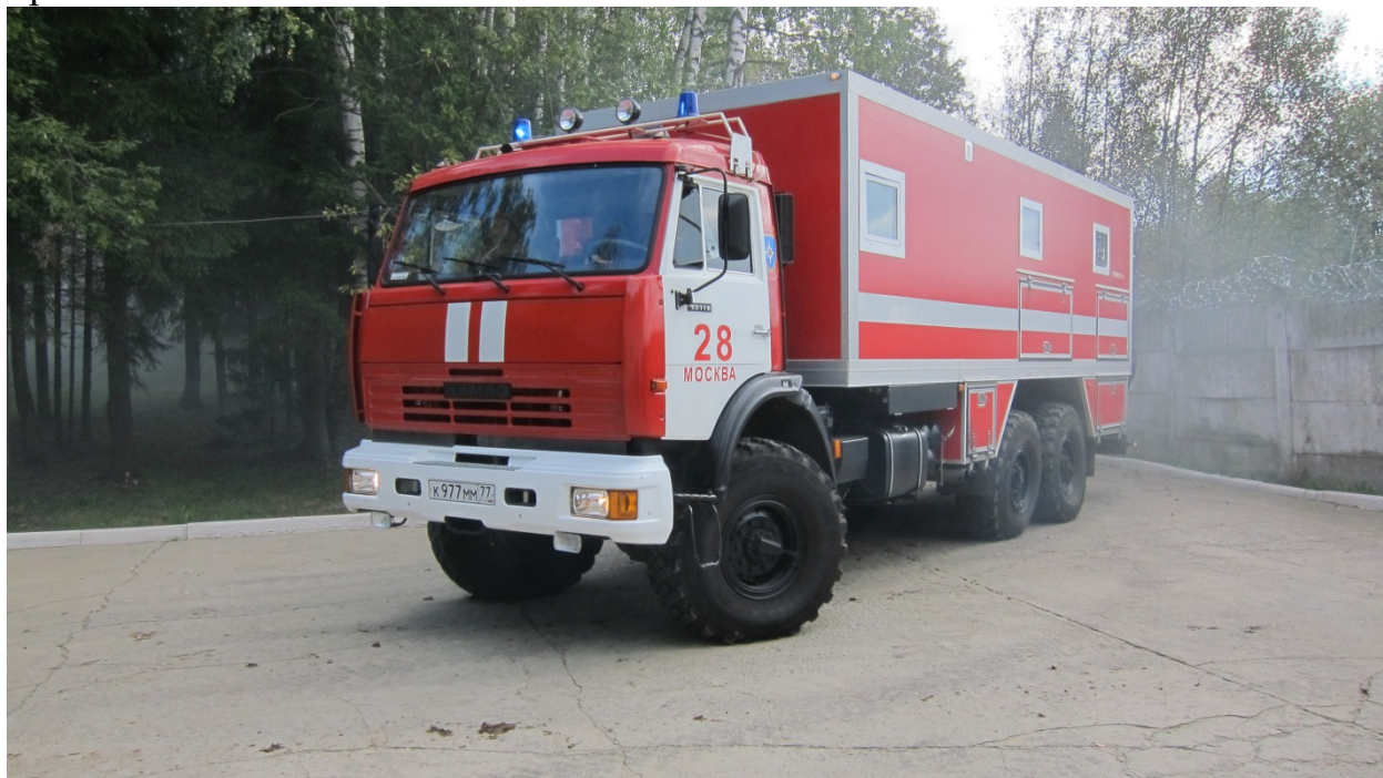
Многоцелевой пожарно-спасательный автомобиль с установкой пожаротушения температурно-активированной водой АПМ 3-2/40-1,38/100-100 (43118) мод. ПиРоЗ-МПЗ
